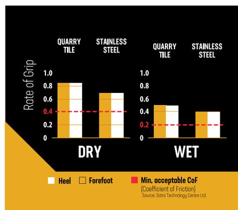
Exemple de résultats à coefficient de friction trouvés sur les étiquettes de suspension attachées à nos chaussures de sécurité TARANTULA ANTISLIP<sup>MD</sup>.
